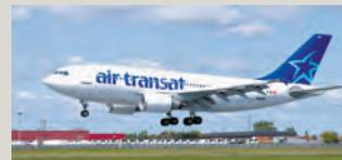
supportent bien les hautes températures, les pilotes d'Air Transat n'utilisent les inverseurs de poussée qu'à la puissance minimum après l'atterrissage, ce qui réduit la consommation de carburant et le bruit.
